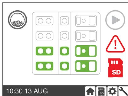
Il messaggio di errore della scheda SD indica che la scheda SD è piena o mancante. Se mancante, installare una nuova scheda (vedere [“Installazione e rimozione della scheda SD”](#) a pagina 10). Nel caso improbabile che la scheda sia piena, sostituirla con un'altra scheda SD di dimensioni equivalenti.
