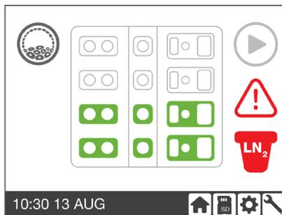
Il messaggio di errore dell'azoto liquido indica che il contenitore di azoto liquido non è stato installato. Installare il contenitore di azoto liquido ponendolo nella posizione corretta rispettiva in Gavi.
