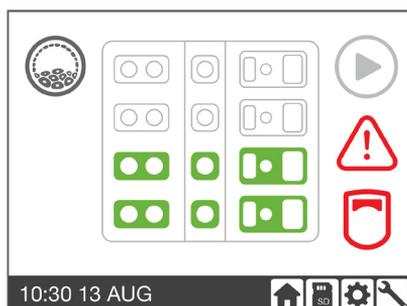
Il messaggio di errore del coperchio di sigillatura indica che Gavi ha rilevato un malfunzionamento durante il processo di trasferimento di un coperchio con guarnizione su un pod di Gavi.
