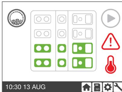
Il messaggio di errore della temperatura indica che Gavi è al di fuori dell'intervallo di temperatura operativa normale consigliato, oppure che il modulo Peltier di Gavi è al di fuori del suo intervallo di temperatura accettabile. Accertarsi che la temperatura ambiente sia compresa tra 18 °C e 27 °C.
