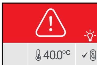
La alarma de iluminación de la cámara se activa cuando el LED de iluminación presenta un fallo y no se apaga. La alarma de iluminación de la cámara se detendrá cuando el LED de iluminación se apague. Esto puede requerir apagar la cámara (consulte “4.4.4. Interruptor de encendido/apagado de la cámara” on page 21).
