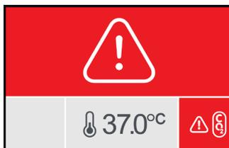
La alarma de gas se activa cuando el nivel de CO<sub>2</sub> dentro de la cámara está fuera de los puntos de ajuste del rango de CO<sub>2</sub> especificado (calculado durante un período de dos minutos). La conexión de la alarma externa también se activa en el mismo momento.
